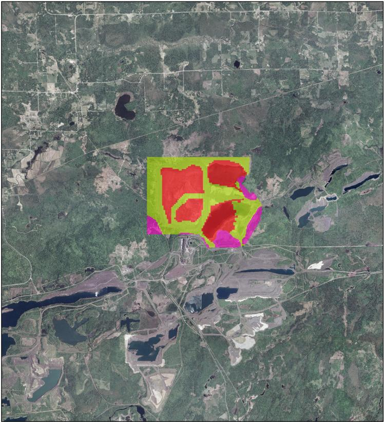
Hydraulic Conductivity (cm/sec) Model Layer 7 8.0 x 10<sup>-9</sup> 1.1 x 10<sup>-5</sup> 5.4 x 10<sup>-5</sup>
